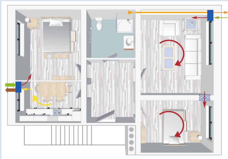
Hier werden zwei Lüftungsgeräte eingesetzt. Das erste versorgt das Schlafzimmer mit Zu-luft. Sie strömt dann in den Flur und wird aus der Küche abgesaugt. Das zweite Gerät ist im Wohnzimmer montiert. Das Kinderzimmer ist mit einem aktiven Überströmer (Ventilator, der die Luft transportiert) angeschlossen. Auch hier strömt die Luft in den Flur und wird dann aus dem Bad abgesaugt.
