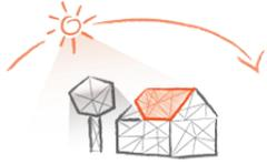
Einstrahlung und Verschattung werden berechnet. Stark verschattete Bereiche werden als nicht geeignet identifiziert. Für die übrigen Dachflächen wird die Einstrahlung für den Verlauf eines ganzen Jahres bestimmt.
