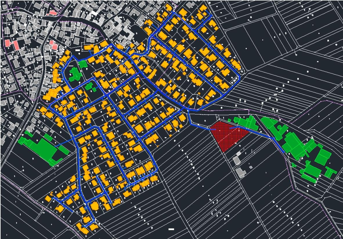
**Abbildung 2-2: Verlauf der großen Wärmetrasse mit angeschlossenen Abnehmern**
